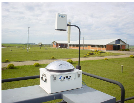
Figura 7.1 – Imageador Total Sky Imager TSI-440 (YES, Inc) instalado na estação SONDA – SMS no Observatório Espacial do Sul – OES/CRS/INPE – MCT.
