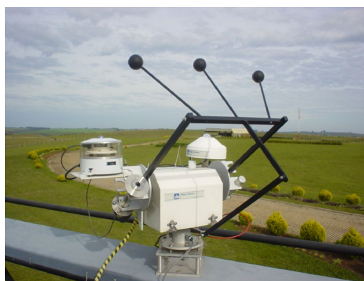
Figura 7.2 - Two Axis Positioner ( Kipp & Zonen ) – 2 AP (“ Tracker ”) instalado na estação SONDA – SMS no Observatório Espacial do Sul – OES/CRS/INPE – MCT.
